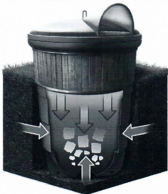
Рис. 4.3 –Пример заглубленного подземного контейнера
