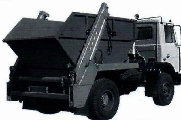
Рис. 8.3 - Бункеровоз МКС-3501 на шасси МА3-5551А2
