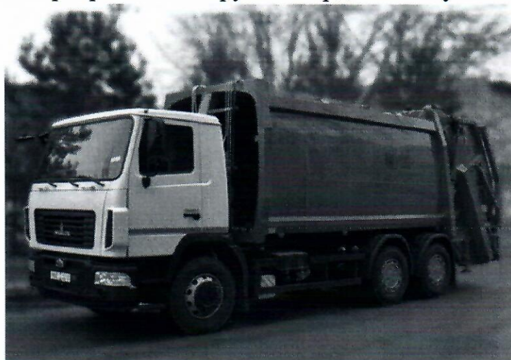
Рис. 8.2 - Мусоровоз с боковой загрузкой КО-427-90 на базе шасси MA3-6312C3
